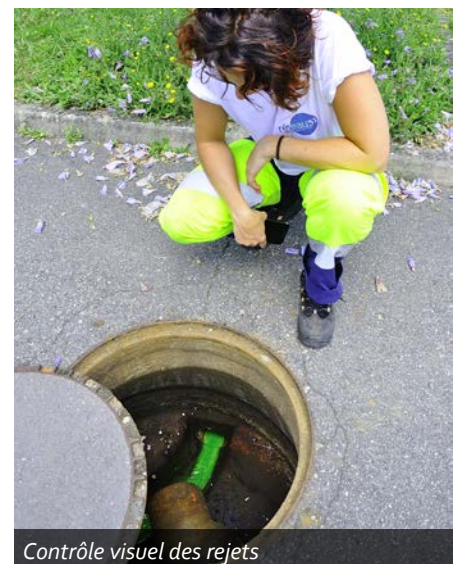
Contrôle des rejets avec colorant végétal
