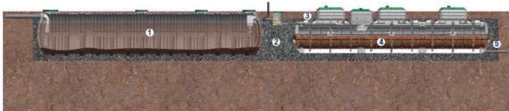
① Fosse toutes eaux avec préfiltre intégré ② Répartiteur externe d'alimentation à auget basculant (en cas de filtres en batterie) ③ Cuve(s) avec Filtre compact coco Premier Tech ④ Milieu filtrant (fragments de coco) ⑤ Évacuation de l'effluent traité
