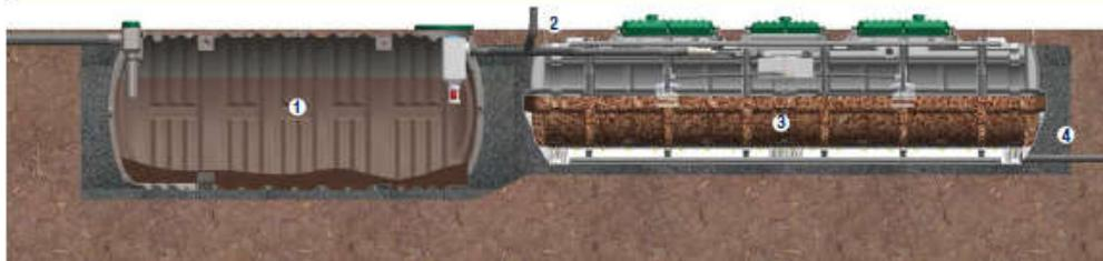
1 Fosse toutes eaux avec préfiltre intégré 2 Cuve(s) avec Filtre compact coco Premier Tech 3 Milieu filtrant (fragments de coco) 4 Evacuation de l'effluent traité (boîte de prélèvement, option très conseillée)
