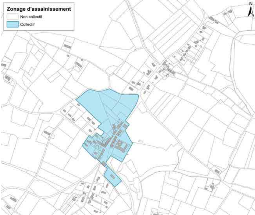
Exemple de zonage d'assainissement
